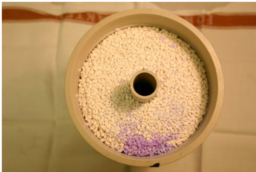
Figur 4: Koldioxidabsorbern efter demontering. En del klumpar kan noteras i nederkant av absorberhuset. Den lila färgen indikerar att kalken är förbrukad.
