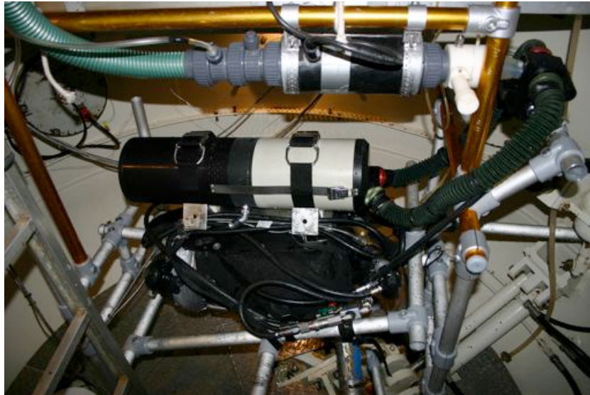
Figur 7: Dykapparaten monterad på docka i tryckkammare före vattenfyllning.
