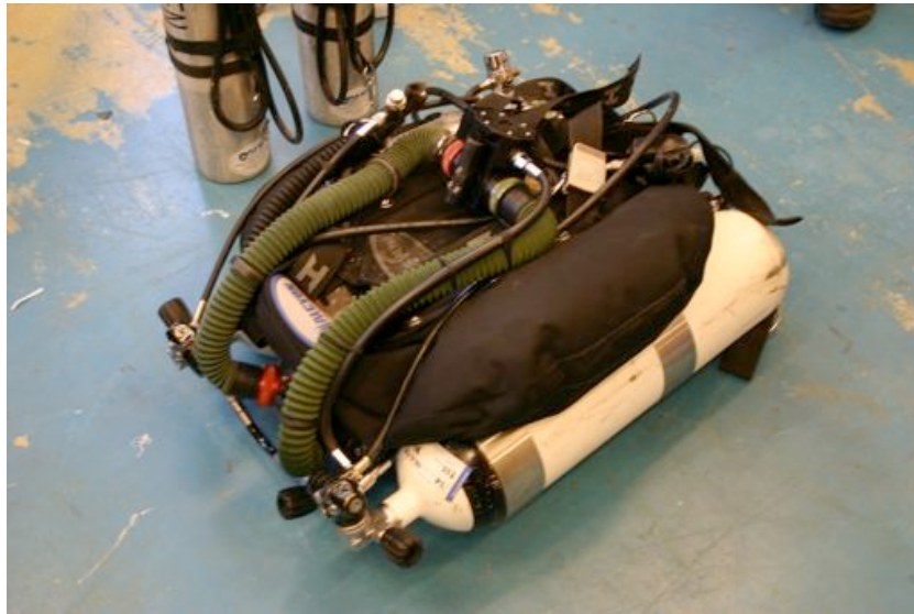
Figur 1: Dykapparaten såsom den levererades till DNC. De två flaskorna som syns i bakgrunden är dels en flaska med ren syrgas för dekompression och dels en flaska med triox som försörjde återandningsapparaten med gas under dyket.
